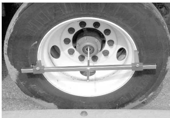
Figura 20. Extensión de terminal de la rueda instalada
