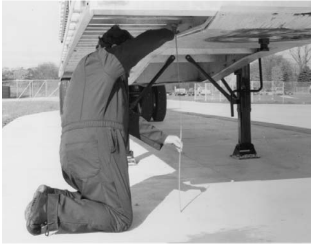
Figura 16. Midiendo la altura actual del perno rey
