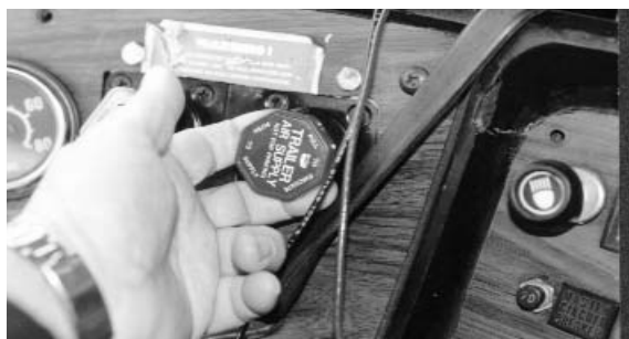
Figura 3. Libere los frenos de estacionamiento del remolque para levantar el remolque
