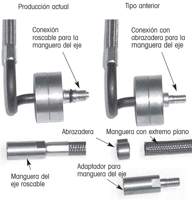
Figura 14. Conexiones de junta rotativa / manguera del eje
