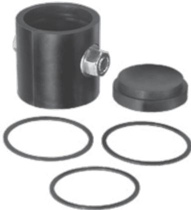
Para dar servicio a los bujes extremos bar pin utilizados en las suspensiones de viga igualadora HAULMAAX se requiere la utilización de herramientas especiales. El juego de adaptadores Hendrickson No. 66086-103 se utiliza con la viga removida del camión, en conjunto con la placa para prensa OTC No. 51100 y una prensa hidráulica de 100-toneladas.
