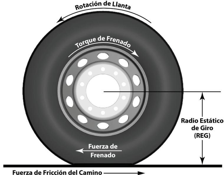
Las tablas a continuación resumen los tamaños estándar de llantas para remolque dentro de carretera y el radio estático de giro (REG) típico para los patrones de la banda de rodadura del remolque. Por favor, consulte con el fabricante de la llanta para obtener el REG exacto para el tamaño, la banda de rodadura y el rango de carga de su llanta específica.
