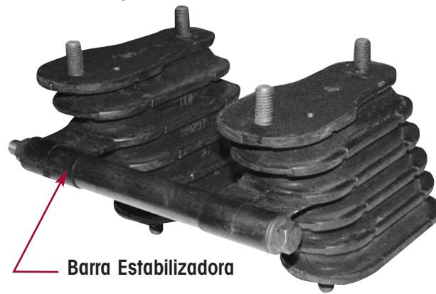
Figura 2 Haulmaax 460 Ensamble de Fuelle para Producción Nuevo con Barra Estabilizadora
