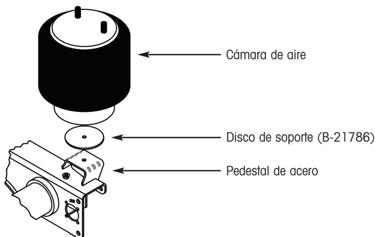
Por favor note que el disco de soporte **es todavía requerido** cuando se reemplace la cámara. Como se menciona anteriormente, usted puede re-utilizar el disco de soporte de la cámara de aire que está siendo remplazada. Si se requiere un nuevo disco de soporte, por favor ordene el equivalente de refacción, número de parte S-21786. Por favor consulte la tabla abajo para mayor información.
