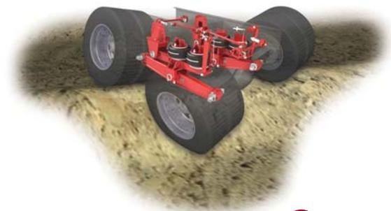
La AR2 proporciona la versatilidad para sitios de trabajo demandantes o condiciones extremas fuera de carretera. Cuando esta cargada, la AR2 proporciona hasta 14 pulgadas\* de articulación diagonal de las llantas para mantener la carga en todas las llantas motrices. La articulación sin carga varía con la configuración del vehículo y el peso del equipo aliado vacío.
