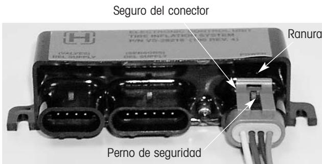
Figura 29. Partes típicas de un conector
