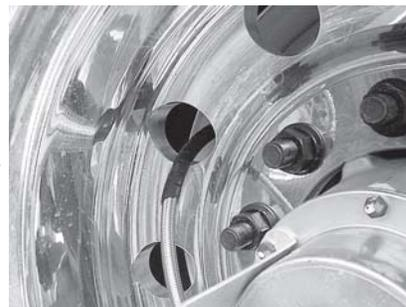
Mangueras para llantas, con guarda protectora instalada. La guarda previene que las mangueras de acero trenzado desgasten los rines.
