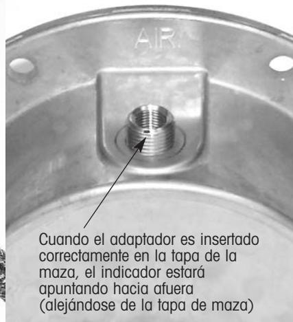
Cuando el adaptador es insertado correctamente en la tapa de la maza, el indicador estará apuntando hacia afuera (alejándose de la tapa de maza)
