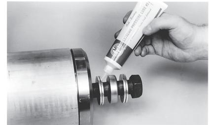
12. Ensamble la herramienta para buje TRI-FUNCIONAL III, el tornillo de cabeza hexagonal, las arandelas, el balero de carga y la placa frontal de la herramienta, como se muestra en la Figura 8-11.
