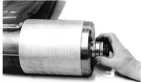
16. Utilice una pistola de impacto de  $\frac{3}{4}$ " y un dado de impacto de servicio pesado de  $1\frac{1}{16}$ " (seis puntos), instale el buje girando el tornillo de cabeza hexagonal en el sentido de las manecillas del reloj, ver la Figura 8-30. Cuando el buje esté aproximadamente a la mitad del tubo extremo del ensamble de la viga del eje, la pistola de impacto puede disminuir la velocidad. Después de muy poco tiempo, la pistola volverá a acelerar.
