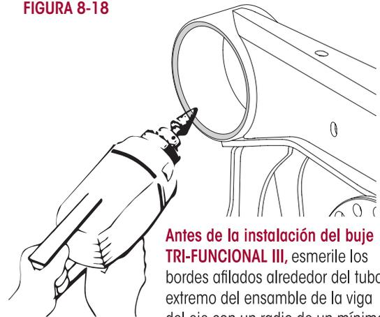
**Antes de la instalación del buje TRI-FUNCTIONAL III**, esmerile los bordes afilados alrededor del tubo extremo del ensamble de la viga del eje con un radio de un mínimo de  $\frac{1}{8}$ " a un máximo de  $\frac{3}{16}$ "
