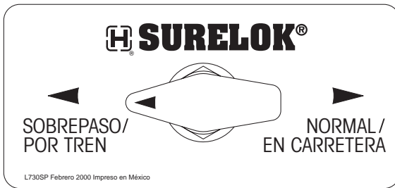
Figura 4. Desactivando el SURELOK, antes de desfogar la suspensión de aire
