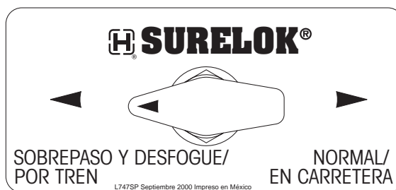
Figura 6. Desactivando el SURELOK y desfogando la suspensión de aire
