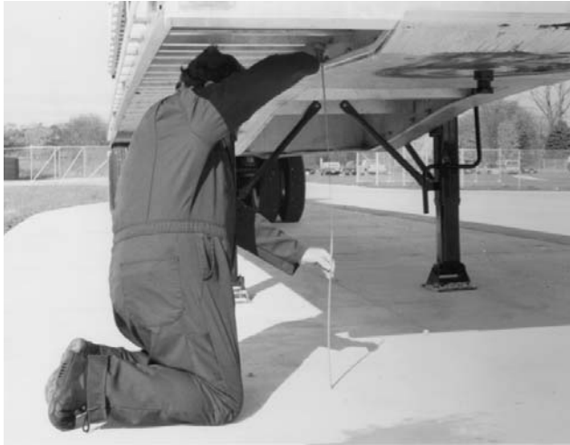
Figura 16. Midiendo la altura actual del perno rey
