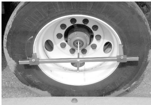
Figura 20. Extensión de terminal de la rueda instalada
