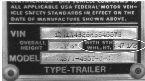
Figura 4: Ejemplo de placa de identificación de remolque
