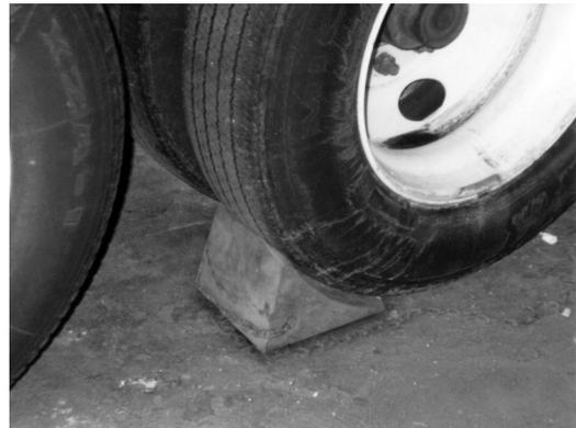
Figura 1: Bloquee las llantas del remolque
