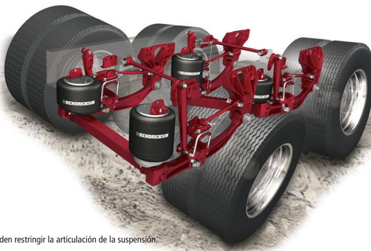
1. El viaje del eje puede ser limitado por el fabricante del vehículo; los topes de los ejes pueden restringir la articulación de la suspensión.
