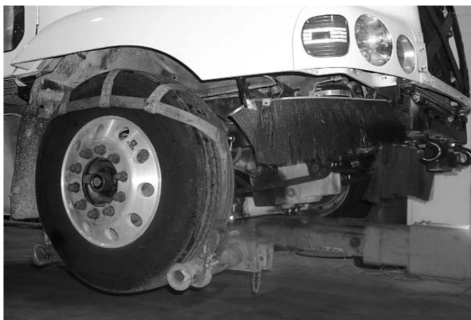
Figura 1 METODO DE LEVANTE EN LLANTAS DELANTERAS
