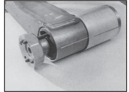
**5** REMOCIÓN Atornille el tornillo en la placa de colocación con los tornillos de ajuste de 2" entrando en los orificios del buje. Retire el buje usando un torquímetro de 3/4".
