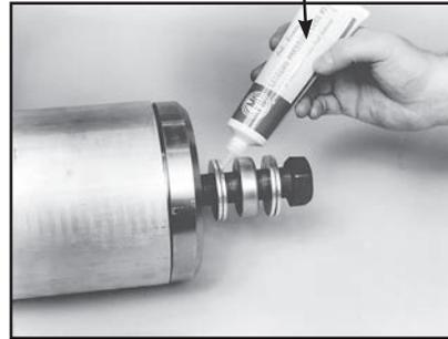
**3** REMOCIÓN Coloque 2 (dos) rondanas en cada lado del balero de carga. Lubrique las rondanas, el balero y las roscas del tornillo.
