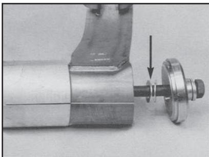
**2** INSTALACIÓN Coloque 2 (dos) rondanas debajo de la placa frontal como se muestra.
