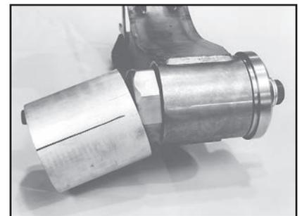
**5** INSTALACIÓN El tubo de transición caerá antes de que el buje esté asentado. Continúe apretando el tornillo hasta que deje de moverse.
