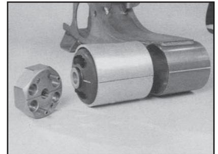
**4** INSTALACIÓN Coloque el lado cóncavo de la placa de colocación contra el buje con los 2 (dos) tornillos de ajuste cortos entrando en los orificios del buje.
