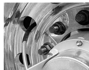
Inspeccione la manguera para llantas por un ruteo adecuado. La manguera para llantas no deberá estar estirada o rozando la superficie de los rines.
