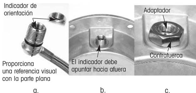
Figura 6. Detalles de la conexión de la tapa de la maza al adaptador
