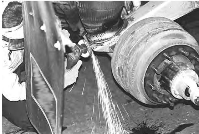
Figura 55. Preparación de los extremos de las vigas de la suspensión trasera
