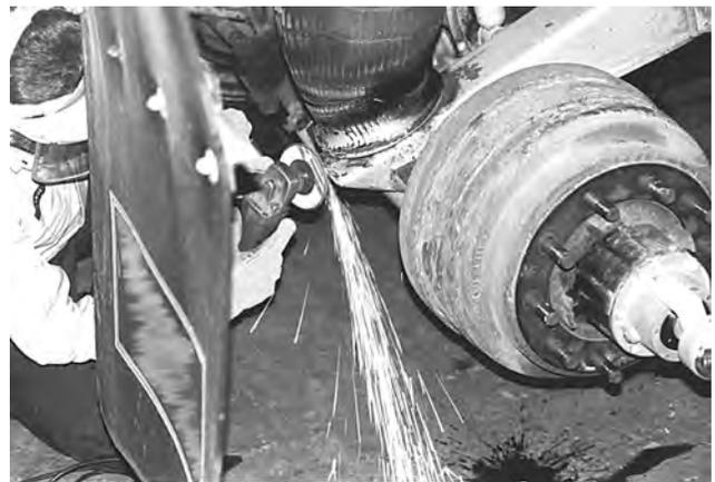
Figura 39. Preparación del extremo de la viga de la suspensión trasera
