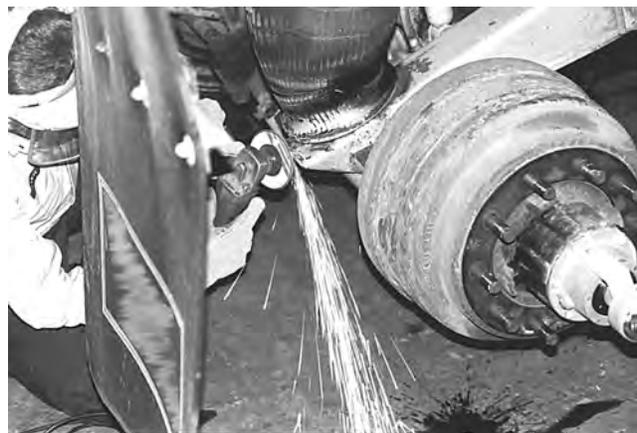
Figura 85. Preparación del extremo de la viga de la suspensión trasera
