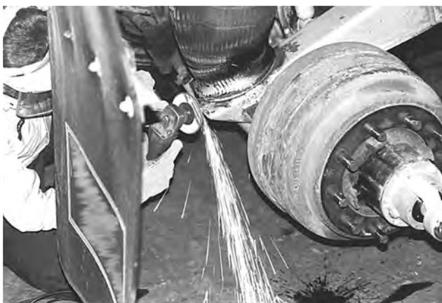
Figura 30. Preparación de los extremos de las vigas de la suspensión trasera
