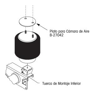
montaje en los agujeros del subensamble del cuadro deslizable y apriete las tuercas de montaje superiores a un torque de 80-100 pie-lbs (108-136 N•m). Si la cámara de aire fue reemplazada, apriete la tuerca de montaje inferior a un torque de 40-50 pie-lbs. (54-68 N•m).
