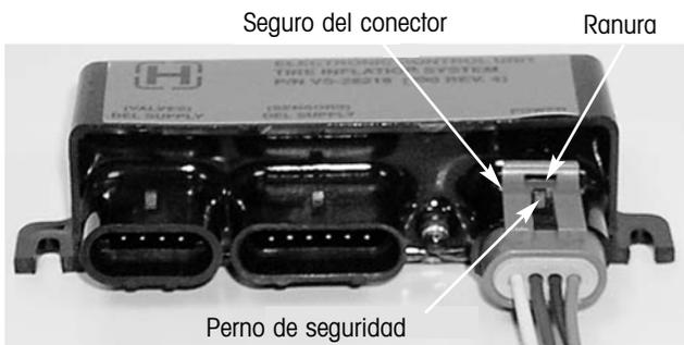
Figura 2. Partes típicas de un conector
