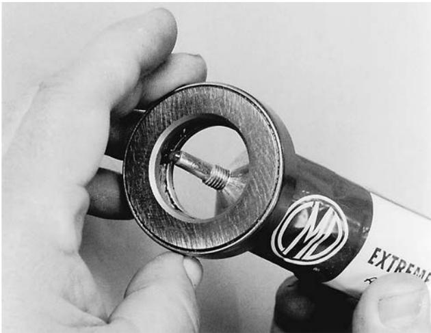
Figura 33: Aplique lubricante al balero de carga
