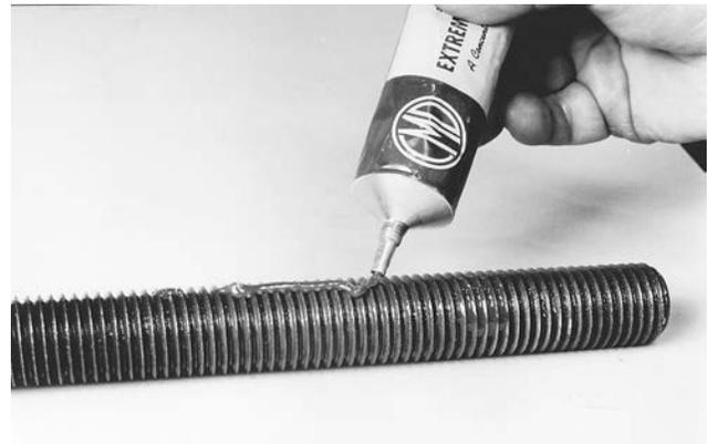
Figura 32: Aplique lubricante al tornillo de cabeza hexagonal
