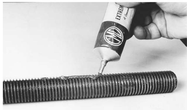
Figura 16: Aplique lubricante al tornillo de cabeza hexagonal
