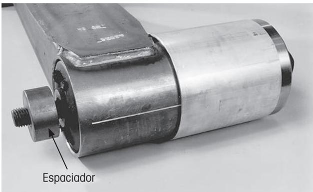
Figura 21: Instalación del espaciador
