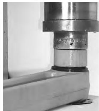
1. Lubrique el diámetro interno del ojo de la viga y el diámetro externo del buje con aceite vegetal (aceite comestible), ver Figura 8-21.
