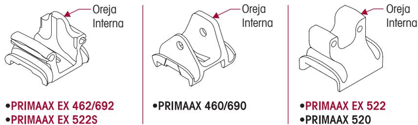
1. Instale la tapa superior en la parte superior del eje enganchando el perno localizador. Se debe tener cuidado para asegurar que la oreja más alta de la tapa superior es montada hacia el lado interno de la suspensión. La tapa superior varía con los diferentes modelos y puede verse diferente, ver Figura 8-25.
