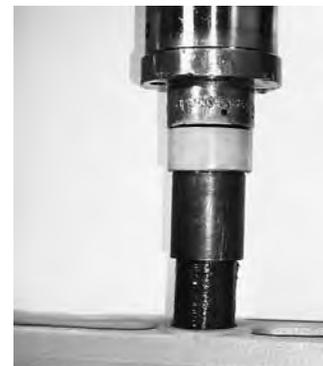
5. Empuje directamente en la herramienta para remoción del perno D hasta que el buje del perno D sea sacado del agujero de la viga.
