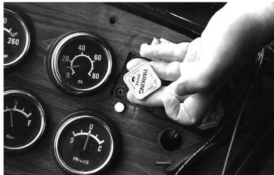
En remolques equipados con una válvula automática de desfogue, al aplicar los frenos de estacionamiento, automáticamente la suspensión de aire comenzará a vaciarse.
