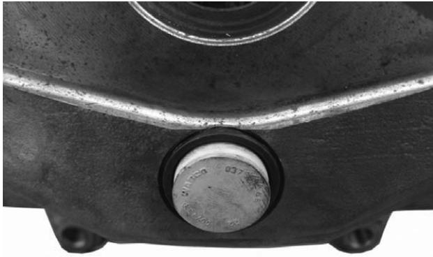
Figura 88: Tapón del ajustador correctamente insertado
