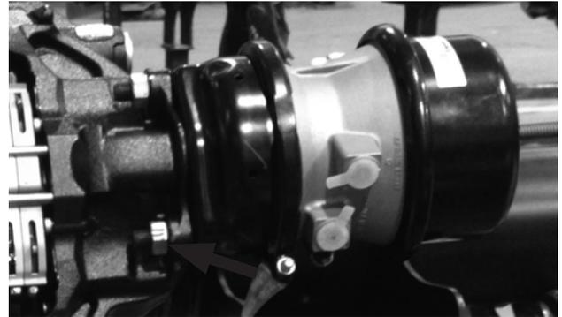
Figura 46: Instalación de la cámara de freno
