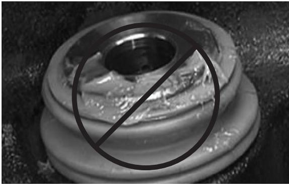
Figura 63: Grasa excesiva en el perno guía y la funda
