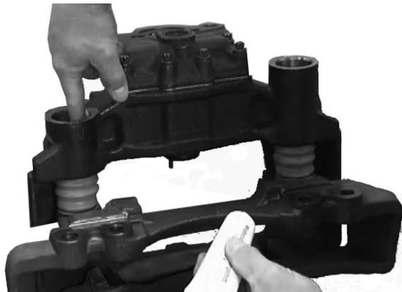
Figura 68: Orificio de engrasado de la tapa del perno guía
