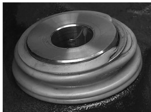
Figura 62: Asiento incorrecto de funda de protección en el perno guía
