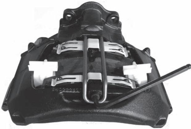
Figura 36: Asegure la barra de sujeción de pastas con el tornillo de sujeción
