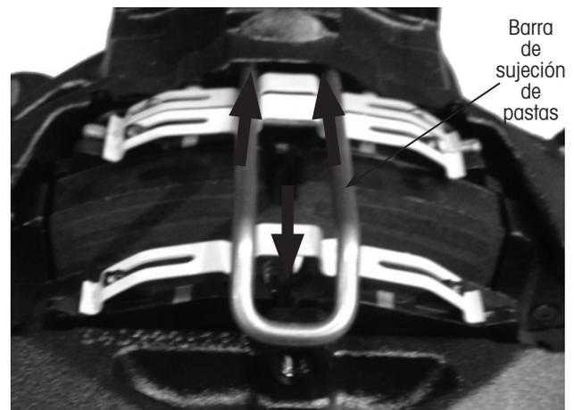
Figura 35: Instalación de barra de sujeción de pastas
