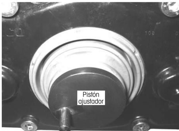
Figura 78: Funda de pistón ajustador correctamente instalada
