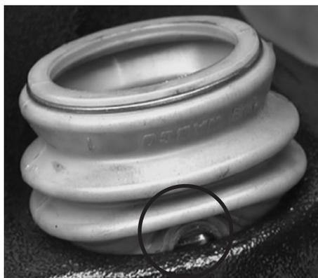
Figura 25: Asentamiento incorrecto de funda de protección de perno guía
