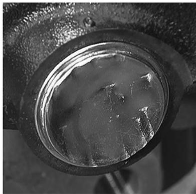
Figura 4: Tapa de perno guía dañada
