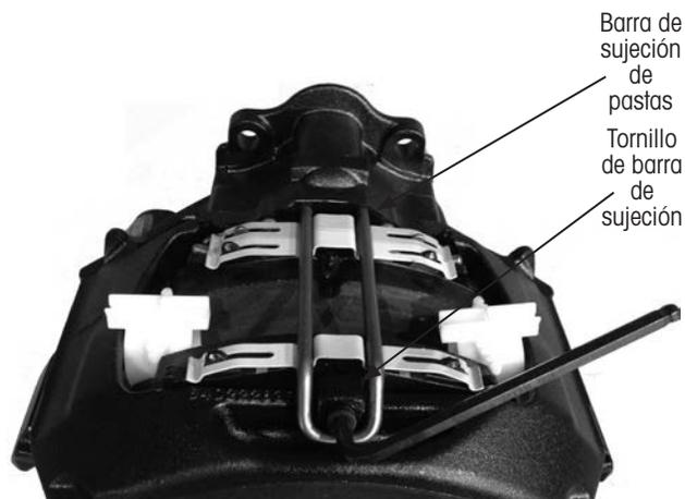
Figura 16: Remoción de tornillo de barra de sujeción
