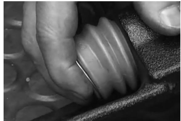
Figura 60: Asiento de funda de protección en el perno guía
