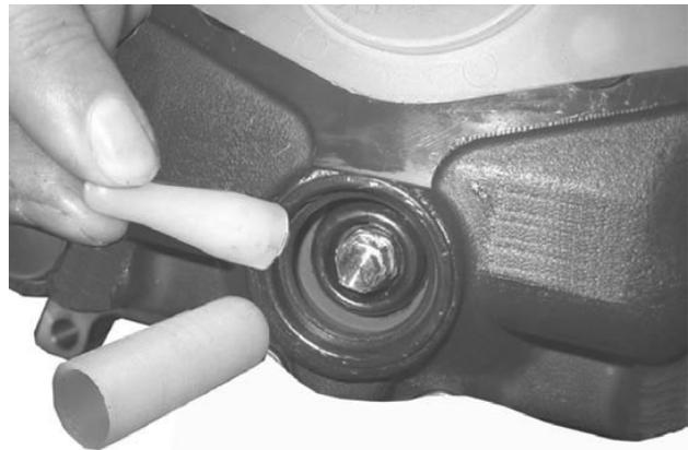
Figura 85: Remoción de buje de montaje y tapa
