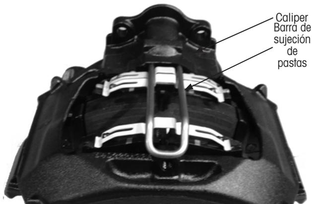
Figura 17: Afloje la barra de sujeción, antes de removerla
