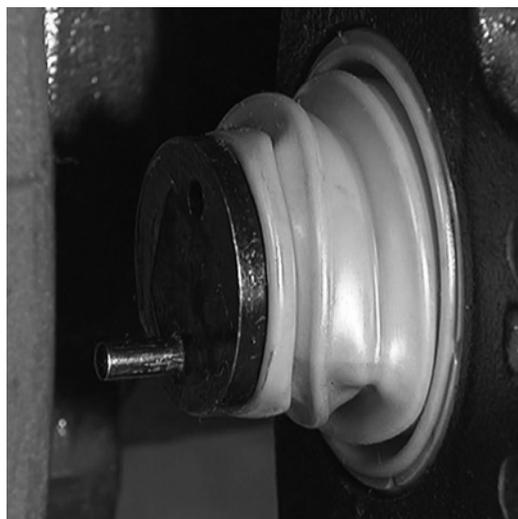
Figura 28: Funda de pistón ajustador arrugada
