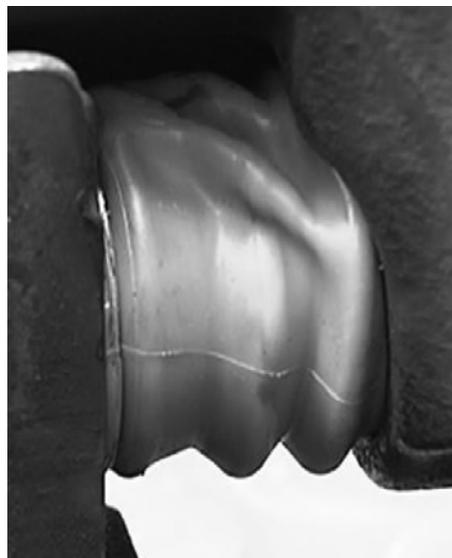
Figura 26: Funda de protección de perno guía reforzada
