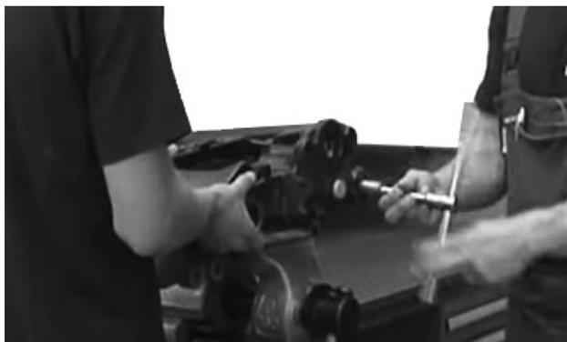
Figura 50: Apoye el caliper remueve los tornillos
