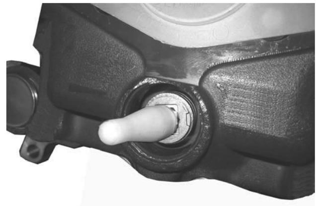
B. Colocación de la tapa de montaje sobre el ajustador
