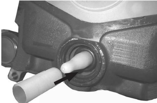
A. **Coloque** un buje de montaje sobre la tapa de montaje (Funda de ajustador mostrada presionada en su lugar)
