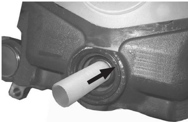
B. **Montaje** del buje sobre la tapa de montaje
