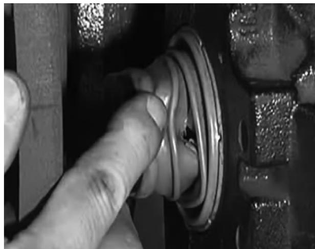
Figura 27: Funda de pistón ajustador dañada
