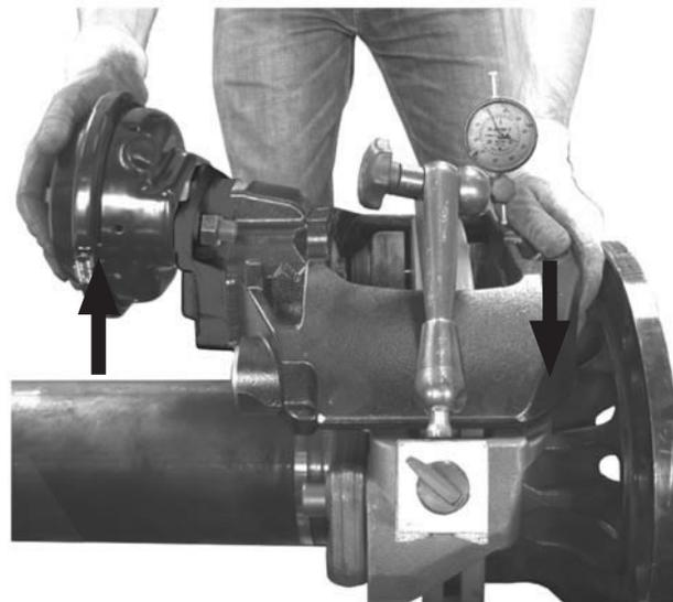
Figura 15: *Inclinación de la cámara de freno lejos del eje*
