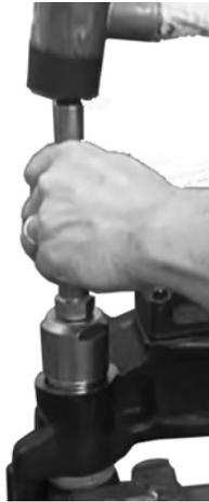
Figura 70: Uso de herramienta para instalar la tapa del perno guía
