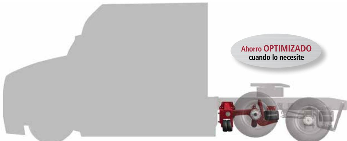
*Eje levantado para una configuración 4x2 — El sistema OPTIMAAX detecta condiciones de carga más ligeras y levanta el eje no motriz*
