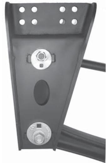
13. Apriete la tornillería QUIK-ALIGN para barra de torsión longitudinal a 525–575 pie libras de torque.
