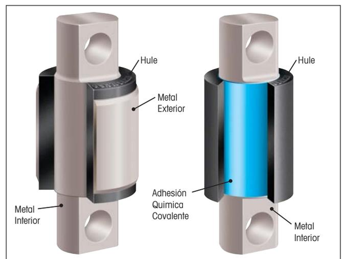
Los bujes convencionales (izquierda) usan camisas metálicas externas para comprimir los bujes de hule en los pernos. El nuevo buje de ULTRA ROD une el buje de hule con el perno, eliminando el metal exterior.
