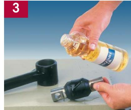
**3** Lubrique el diámetro interno de los tubos extremos de la barra de torsión y los nuevos bujes de hule con aceite vegetal (comestible). **NO USE** lubricante a base de petróleo o jabón.
