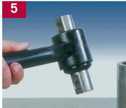
**5** Empuje directamente en el perno del buje tipo espárrago. Exceda la posición final deseada por aproximadamente 3/16".
