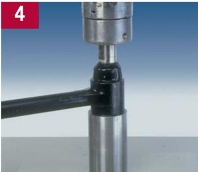
**4** Soporte el tubo extremo de la barra de torsión y céntralo en la herramienta de recibo. Los bujes bar pin tipo espárrago deben tener las partes planas del perno posicionadas al mismo ángulo del buje removido para facilitar la instalación.
