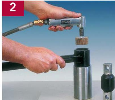
**2** Limpie e inspeccione el diámetro interno de los tubos extremos de la barra de torsión, remueva la suciedad o rebabas con una lija o pulidor.
