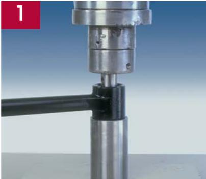
**1** Soporte el tubo extremo de la barra de torsión y céntralo en la herramienta de recibo. Empuje directamente en el perno del buje tipo espárrago hasta que el buje salga del tubo extremo de la barra de torsión.
