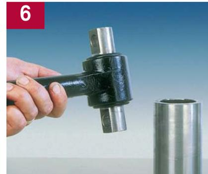
**6** Empuje el buje nuevamente por el lado opuesto y centre el buje con respecto al tubo extremo. Permita que el lubricante se disipe por cuatro horas antes de instalar la barra de torsión.
