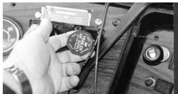
Figura 3. Libere los frenos de estacionamiento del remolque para levantar el remolque
