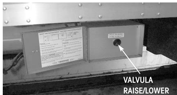
Figura 4. Estire la válvula RAISE/LOWER
