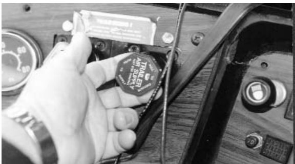
Figura 7. Libere los frenos de estacionamiento del remolque para levantar el remolque
