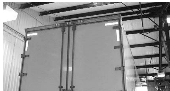
Figura 2. Verifique el claro arriba del remolque
