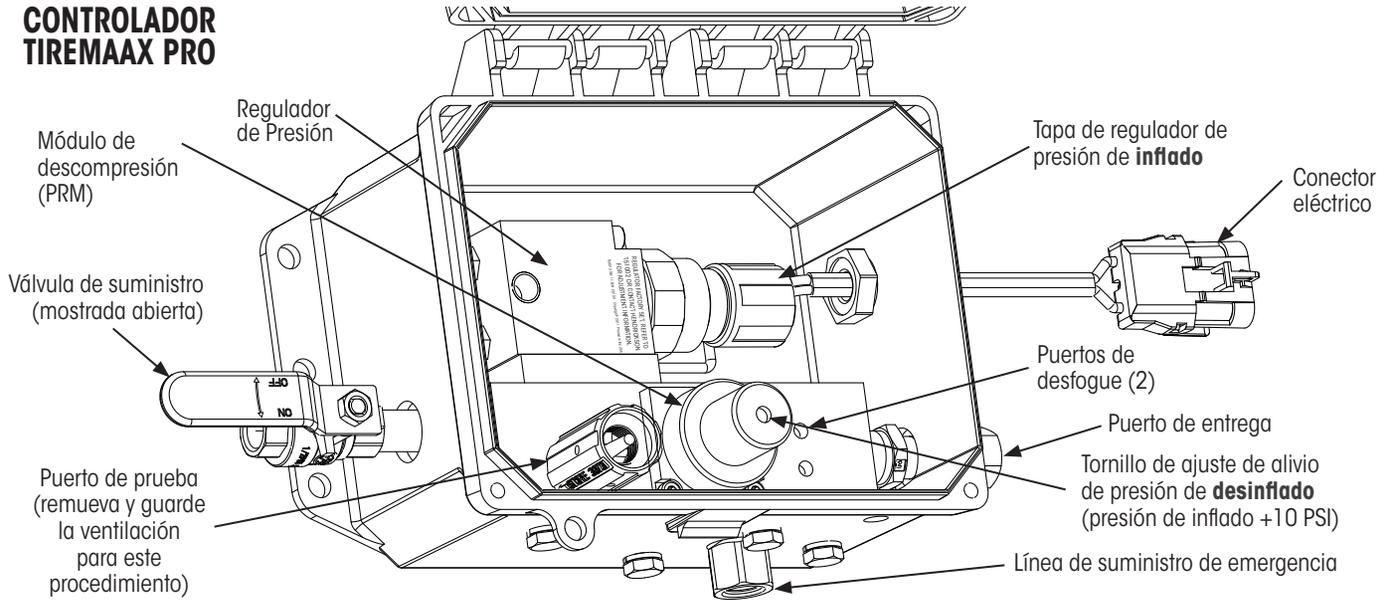
**\*IMPORTANTE:** Después de ajustar la presión más baja, presione el botón de alivio de presión del calibrador objetivo para permitir que escape el aire, luego suéltelo antes de leer el medidor.
