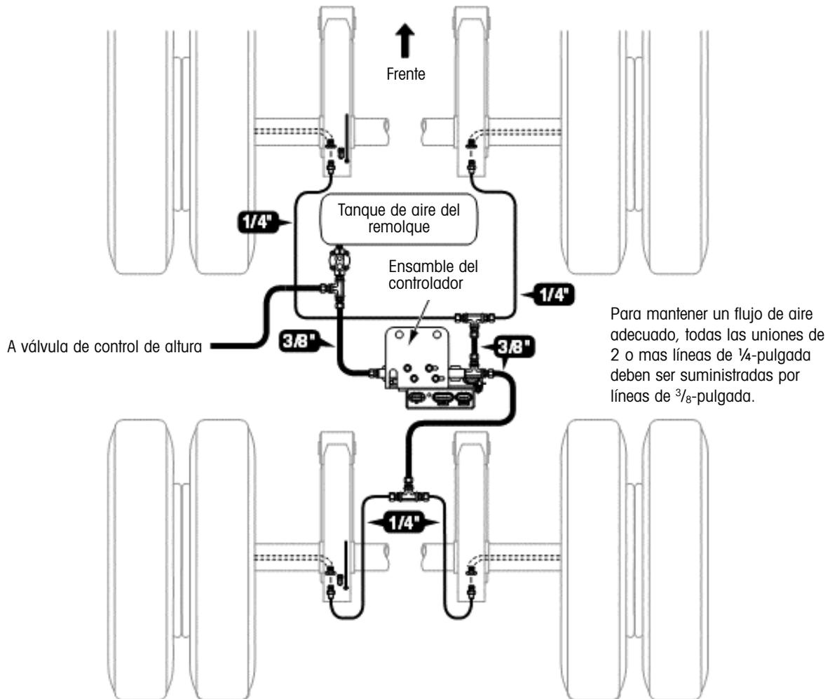
Cuando se usa el diámetro incorrecto en las líneas de aire, la sensibilidad para detectar fugas del ensamble del controlador se eleva y la cantidad de aire que fluye hacia las llantas baja. Para detalles completos de instalación de mangueras, información de seguridad y diagramas de instalación de mangueras adicionales, consulte la publicación L818SP TIREMAAX, *Procedimientos de Instalación, Servicio y Diagnóstico*, disponible en [www.hendrickson-intl.com](http://www.hendrickson-intl.com).
